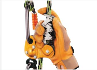
Un semplice appoggio sulla leva di sbloccaggio permette di sbloccare il dispositivo. Al suo rilascio, la leva consente di bloccare nuovamente il dispositivo. La regolazione della pressione su questa leva permette di modulare la velocità di spostamento.
