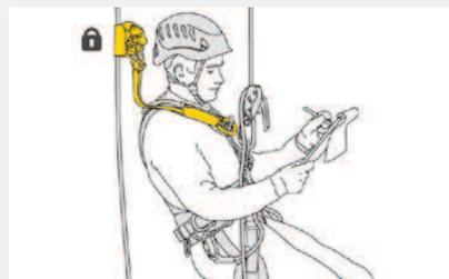
Funzione bloccante che consente all'utilizzatore di arrestare il dispositivo per ridurre l'altezza della caduta.
