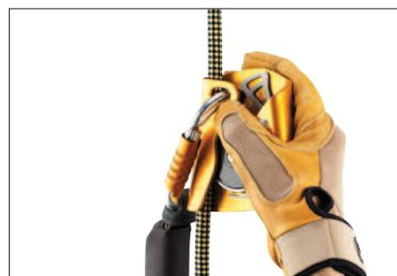
Durante una caduta, un riflesso naturale può portare l'utilizzatore ad afferrare il dispositivo con le mani: gli anticaduta di tipo guidato ASAP LOCK e ASAP funzionano anche in questa situazione.
