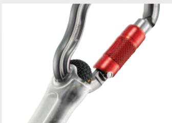
La guaina in plastica sul capo fisso tiene il moschettone in posizione corretta per facilitare il moschettonaggio. Le guaine proteggono anche le estremità del cordino dall'abrasione dovuta ai frequenti sfregamenti.
