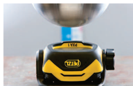
Test di resistenza agli urti
